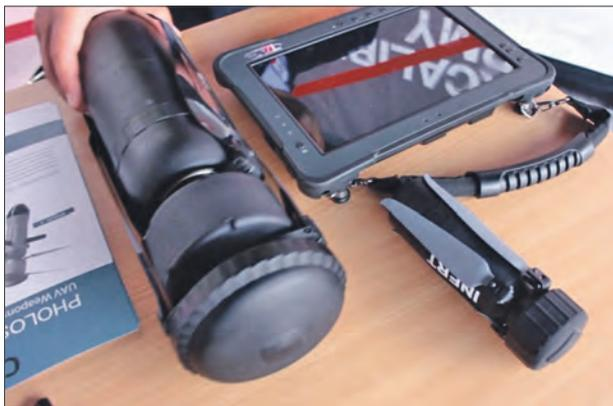
*Противотанковый ББ «Фолос-2» (слева), противопехотный ББ «Фолос» (справа) и переносное устройство управления*
