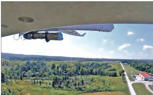
*Барражирующий боеприпас «Свитчблейд-300», подвешенный под крылом БПЛА «Джамп-20»*
