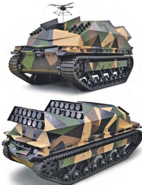
*Макет дистанционно управляемого роботизированного комплекса TRX на гусеничном ходу компании «Дженерал дайнэмикс лэнд системз» для запуска ББ*
