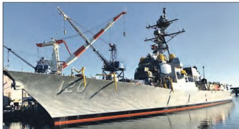
плуатацию которого ожидается летом с. г. Одно из главных отличий от его прежних версий – основная часть оборудования интегрируется в модули до окончательной сборки корабля. Для снижения радиолокационной заметности вертолетные ангары изготовлены из композитных материалов. На верфи в штате Мэн продолжается строительство еще шести эсминцев этого класса.
