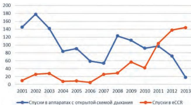
**Статистика проведения водолазных спусков на глубины более 56 м с 2001 по 2013 год**
