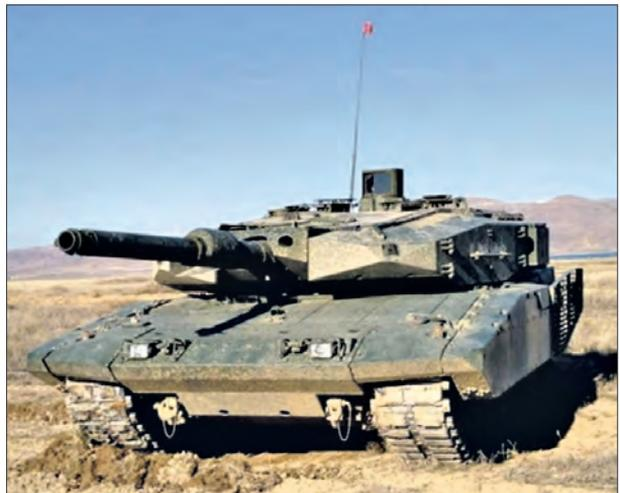
*Танк «Леопард-2А4» со 120-мм гладкоствольной пушкой*
