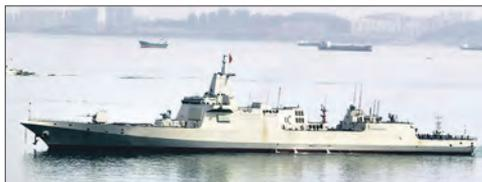
щением 14 500 т. Скорость хода 30 уз, дальность плавания 5 000 миль, экипаж более 300 человек. Основное предназначение эсминцев этого класса – сопровождение авианосных ударных групп. В общей сложности китайский флот планирует принять на вооружение 16 кораблей этого типа.
