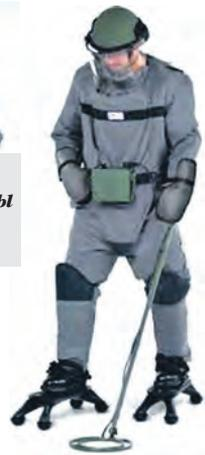
**ПНЕВМАТИЧЕСКАЯ ПЛАТФОРМА, НАДЕВАЕМАЯ НА ШТАТНЫЙ АРМЕЙСКИЙ БОТИНОК ИЛИ ДРУГУЮ ОБУВЬ, В ПРИНЦИП ДЕЙСТВИЯ КОТОРОЙ ЗАЛОЖЕНО СНИЖЕНИЕ ДАВЛЕНИЯ НА ГРУНТ НИЖЕ ПОРОГА СРАБАТЫВАНИЯ ВЗРЫВАТЕЛЯ ПРОТИВОПЕХОТНОЙ МИНЫ**
