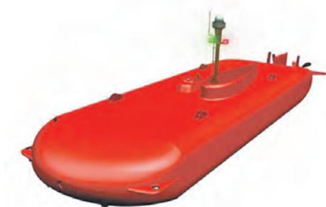
ников. Непосредственно сборка прототипа MUM длиной 25 м начнется летом 2023 года, его оснастят воздухонезависимой силовой установкой на водородных топливных элементах.
